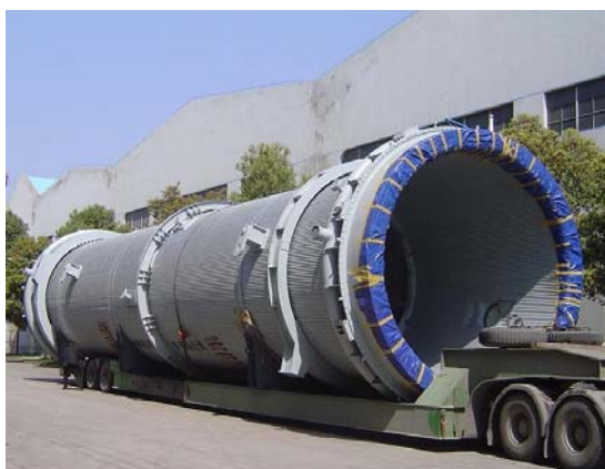
氧气转炉余热锅炉（直段）
