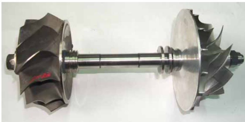
图 6-10 废气涡轮增压器涡轮转子结构图
