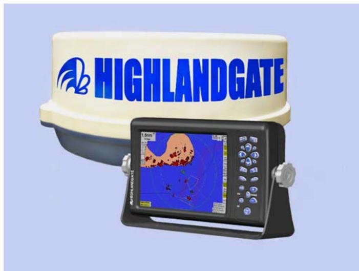
本公司研发的雷达主要由天线收发单元和显示单元两大部分构成。天线收发单元用于发射、接收并处理无线电波，发射部分产生微波，经磁控管传导给天线进行发射，接受部分收到周围所有目标的反射信号，传送到图像处理系统，经过处理后在显示单元显示。显示单元在屏幕上显示收到的图像信号，它本身具有一定的存储容量，可以存储海图数据和用户数据。本产品可以将海图和雷达图像叠加，从而清楚地显示出目标在海图上的位置。
