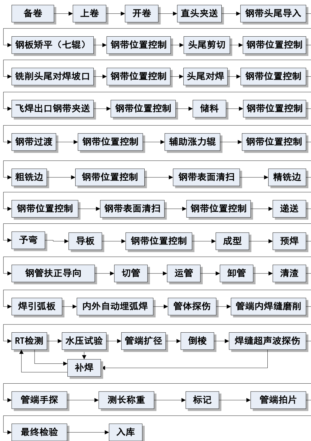
③高频直缝电阻焊管工艺流程：
