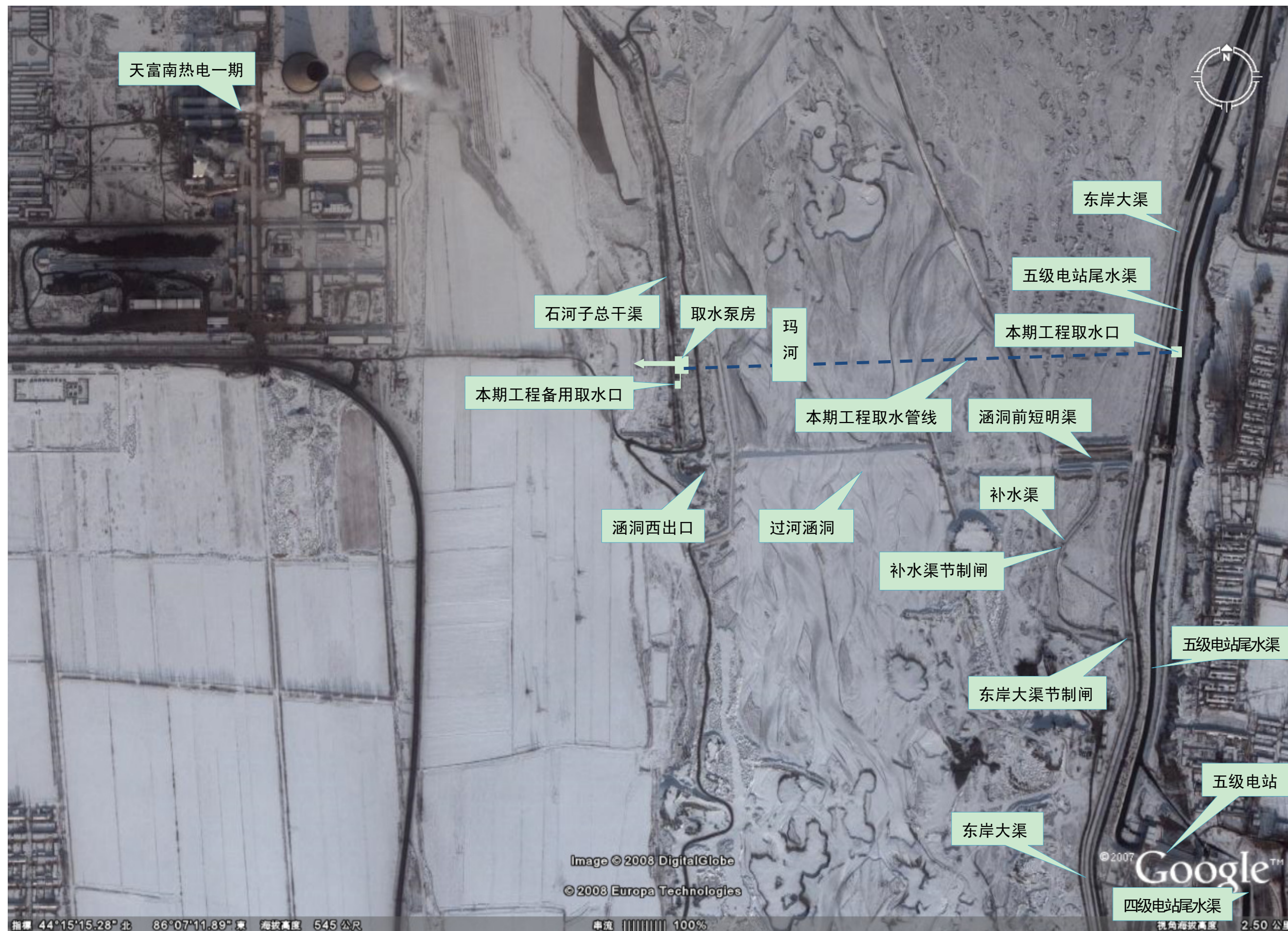
图 5.3-1 厂区附近玛纳斯河水利工程
