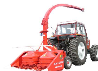
9QSD-2200 型青饲料多用途收获机（配双向拖拉机）
