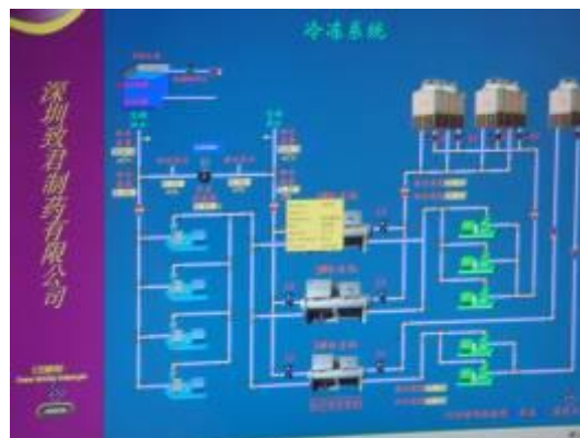
致君制药中央空调水系统变流量控制系统
