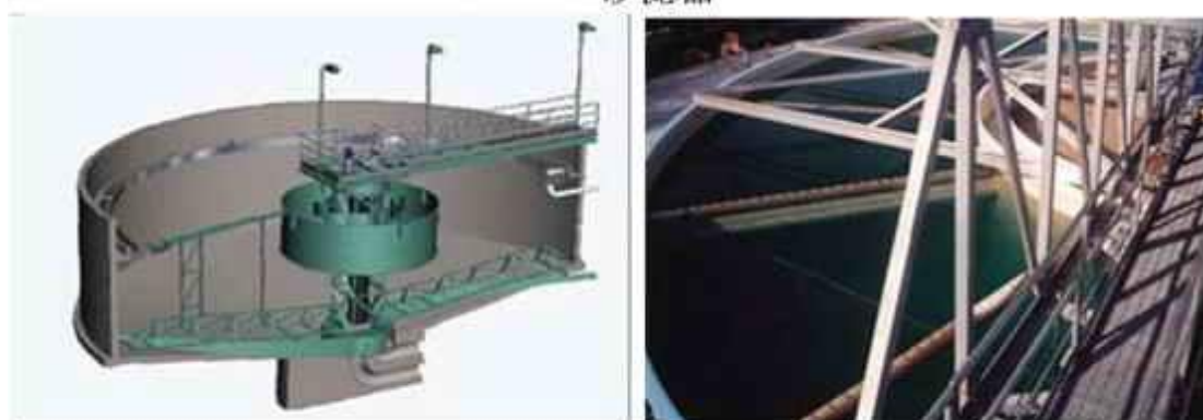
机械搅拌澄清池
