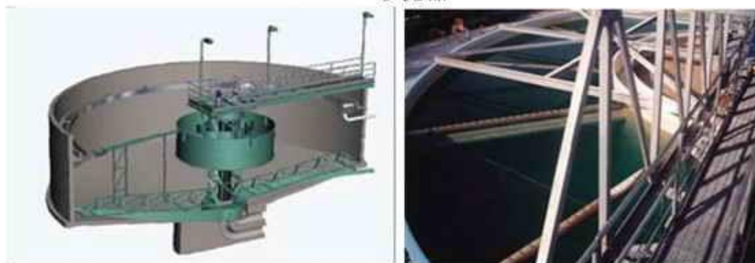
机械搅拌澄清池
