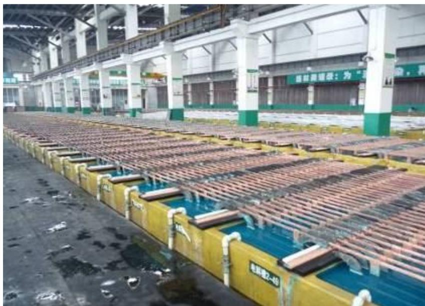
图 4-6 格林美电积铜生产线
