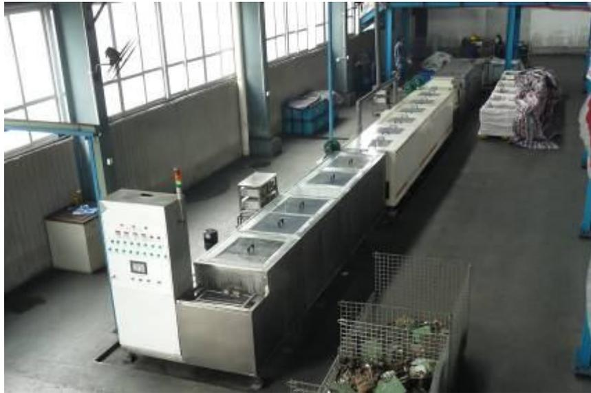
图 4-5 国内第一条线路板自动退锡线
