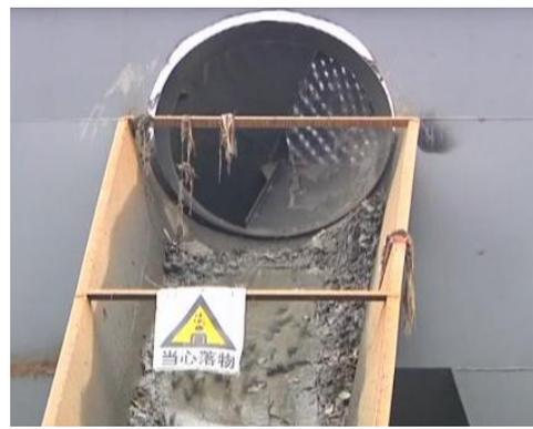
在有机械压滤脱水固结要求的水利疏浚工程中，由于疏浚淤泥中含有大量石块、编织袋等垃圾，影响浚土的机械压滤脱水。为此，需要预先对泥浆进行筛分处理。浙江疏浚经过实验室试验以及具体项目实践，形成了一套有效的泥浆筛分技术。浙江疏浚在挖泥船额定排距终端或淤泥机械压滤脱水固结场地，放置一套由网状滚筒机构、链传动机构及泥浆输送机结合组成的筛分系统装置。疏浚淤泥土方在输送至筛分系统装置后，大于 1cm 的固状物与泥浆将被自动筛选并分离。
