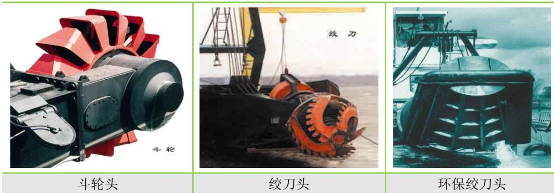
如上图所示，挖掘头部装置有斗轮头、绞刀头和环保绞刀头等三种，不同的挖掘头部装置适用于不同土质的开挖，斗轮头适合开挖硬质土，绞刀头适合开挖软质土，环保绞刀头适合开挖悬浮质及软淤泥。在疏浚施工过程中，由于施工地形复杂、设计开挖深度不一、疏浚土质变化大，单一挖掘头部装置的挖泥船无法满足各类土质的开挖需求，影响施工效率。公司通过长期实践研究开发出的挖泥船挖掘头部装置快速互换技术解决了上述问题。当开挖土质发生变化时，不需要另行调配挖泥船进场，只需要应用该技术将挖泥船的挖掘头部装置快速更换，即可连续施工。该技术的应用可以保障单艘挖泥船能够适应不同土质、不同需要的疏浚土方开挖，大幅度提高施工功效，有效降低施工成本。
