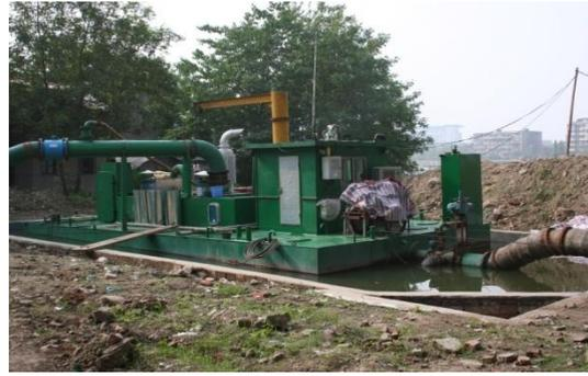
一些水利疏浚工程施工区域离弃土场地较远，超出挖泥船的额定输送距离，针对疏浚淤泥远距离全封闭输送难的问题，浙江疏浚成功研制了接力泵船（站）系统装置，经过反复实践，该装置已熟练应用于远排距水利疏浚工程的施工过程中。该项技术可在输泥管线中途串联与挖泥船同特性接力泵船（站），为疏浚土的输送提供连续的动力，突破目前普遍存在的疏浚土方远距离输送难的瓶颈，实现远距离输送，确保疏浚土全封闭远距离无污染地输送至弃土场。该技术为城市湖泊、城市河道、水库附近无合适弃土场而需远距离安全处置淤泥创造了条件。
