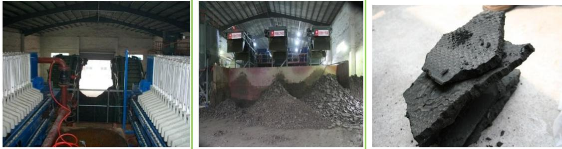
浚土在弃土场自然堆放难以固结，一方面占用了有限的土地资源，另一方面也不利于浚土的后期利用。浙江疏浚与兴源过滤合作开发的疏浚淤泥机械压滤快速脱水固结技术，能够将经过筛分系统装置分离的疏浚淤泥泥浆经过预处理后，充分混合并压注入的隔膜压滤机压滤，达到迅速脱水、固结的效果。该技术的应用不仅极大地提高了弃土场的使用效率，而且为浚土的后续资源化利用创造了条件。
