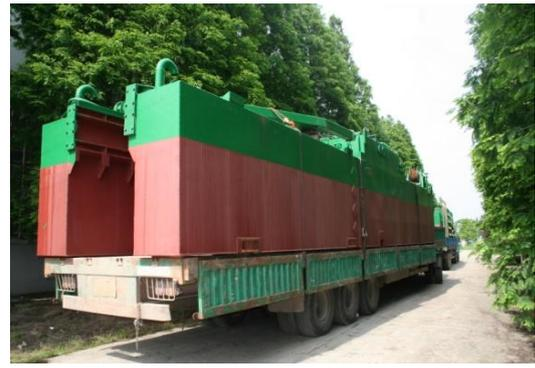
为了解决大型疏浚装备难以通过水路进入封闭水域的难题，满足封闭水域疏浚项目的施工需求，浙江疏浚研制了符合公路交通运输允许条件的分体式挖泥船。挖泥船调遣前，将船体按照运输需求进行分体拆解，用大吨位吊车装入平板车，通过公路网，调遣至施工现场再进行组装。该技术具有安全、可靠、快速和灵活的特点，应用此项技术，可以满足诸多封闭水域的施工需求，如城市湖泊、山区或平原水库等。此外，该技术也解决了其他疏浚项目远距离水路调遣时间长、安全隐患多和费用高等问题，为工程的按时开工提供了有利保障。
