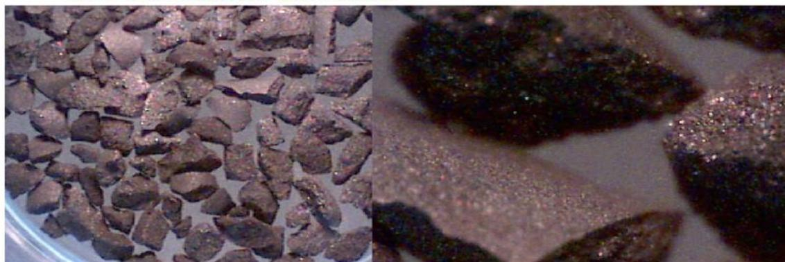
圆柱破碎炭具有圆柱形表面及尖锐棱角
