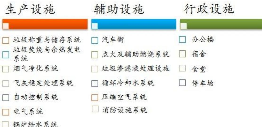
上图中生产设施由垃圾称重与储存系统、垃圾焚烧与余热发电系统、烟气净化系统、飞灰稳定处理系统、自动控制系统、电气系统及锅炉给水系统组成；辅助设施由汽车衡、点火及辅助燃烧系统、垃圾渗滤液处理设施、循环冷却水系统、压缩空气系统及消防设施组成。除上述生产设施及辅助设施外，各垃圾焚烧发电项目还有办公楼、宿舍、食堂及停车场等辅助行政设施。
