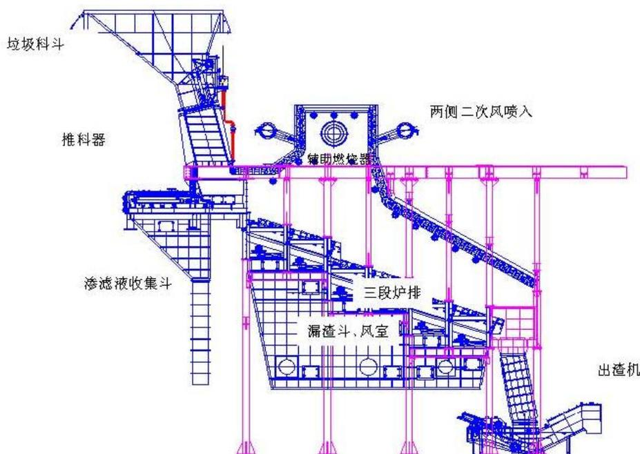
垃圾焚烧炉的组成和工艺过程为：垃圾焚烧系统由炉排系统、焚烧炉壳体、炉渣处理系统、助燃系统、助燃空气系统、自动燃烧控制系统 ACC 等组成。
