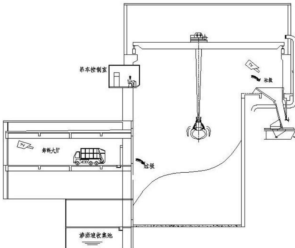
图：垃圾接收、储存和输送系统示意图(剖面)
