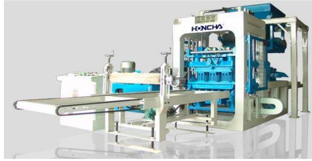
不配置配料机、低位升板机、子母车、码垛系统等辅助设备，从供料至出成品、养护等工艺流程均由人工完成的生产线。
