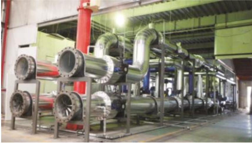
水冷商用空调主机试验装置
