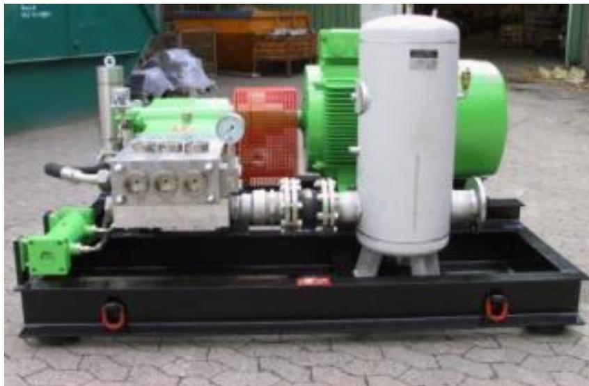
高压水射流成套设备的高压泵机组
