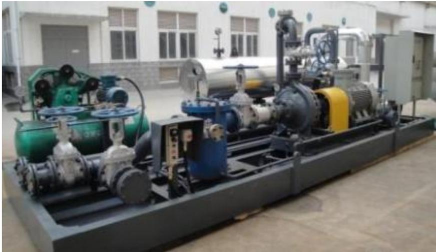
大型储油罐机械清洗成套设备的回收设备
