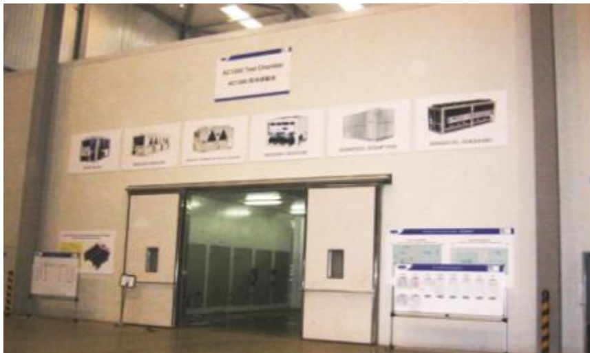
风冷商用空调主机试验装置
