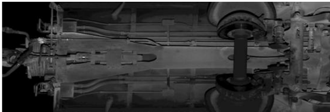
TVDS-3D 拍摄的车底部图像
