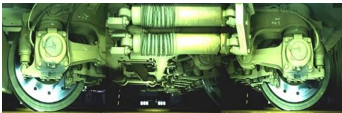
TEDS 拍摄的动车组侧部转向架图像
