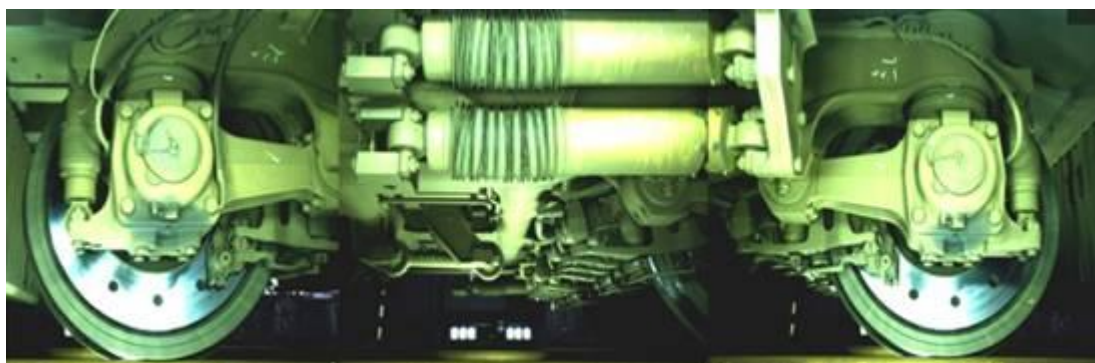
TEDS 拍摄的动车组侧部转向架图像
