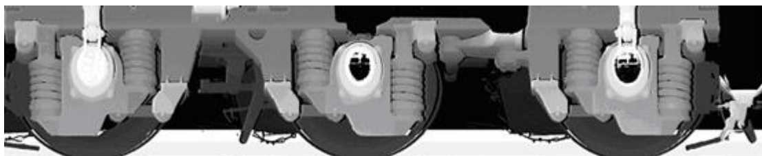
机车走行部动态监视系统拍摄的机车侧部图像
