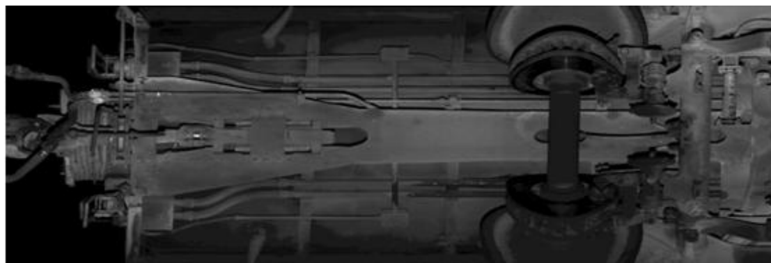
TVDS-3D 拍摄的车底部图像
