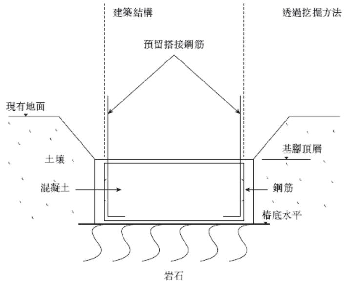
基腳地基為淺地基的一種，將樓宇的荷載轉移至近地面的淺床岩層（通常在地面下不到兩米）。大部份基腳是將混凝土倒入溝內並用某種模具壓制而成。基腳的功能與樁帽相似。然而，基腳將荷載直接轉移至床岩，而樁帽則將荷載轉移至樁柱。
