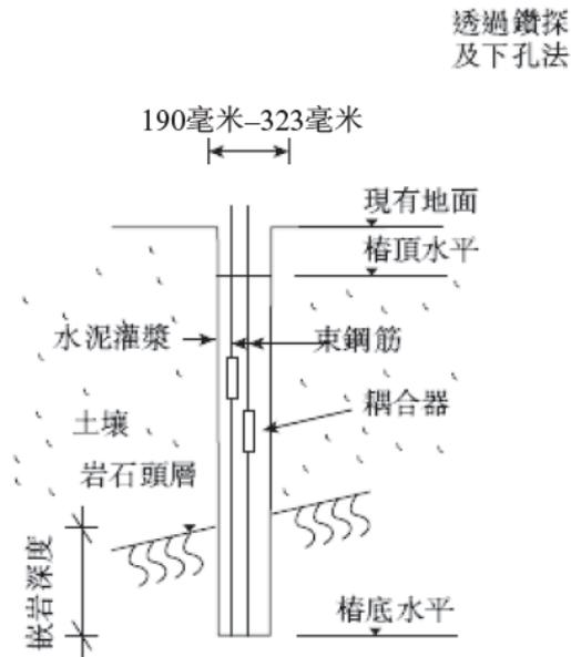
微型樁通常由一根或多根鋼筋插入直徑不超過400毫米的鑽孔內形成。微型樁一般被設計塞入岩石內，主要用於抵抗難以進入地盤的壓縮或拉伸力。在鑽孔作業過程中，須使用套管支撐土壤內的鑽孔及／或破碎岩石。
