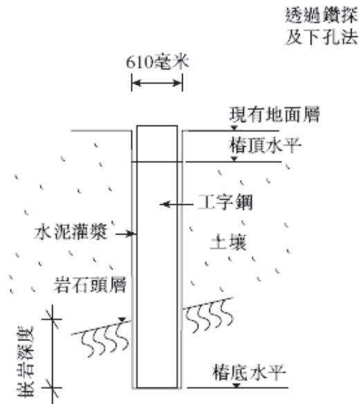
旋轉掘進機為用於在地面鑽孔作打樁之用，並一直鑽探，直到孔已延伸到足夠的深度(套接)和進入一個足夠的地層。鑽孔的直徑和深度在極大程度上取決於地面的狀況、負載條件和建築項目的性質。套接工字樁(亦稱為預鑽工字樁)其後透過將預製的鋼板工字樁插入鑽孔，並陷入床岩，其後以水泥漿灌漿鑽孔。
