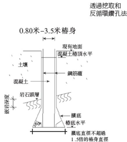
本集團承接的鑽孔樁工程主要是直徑介乎0.80米至3.5米的大口徑鑽孔樁。其形成及安裝過程通常為利用機械打鑽及挖掘至所需水平，然後將鋼筋混凝土注入鑽孔內。一般在鑽孔作業時，鋼管會臨時用以支撐土壤。鑽孔樁屬「端承樁」的一類，達致地下岩床層，鑽孔樁從中得到支持，以承受來自上蓋的荷載。一般會在大口徑鑽孔樁的底部建造擴底，增加鑽孔樁的承受力。
