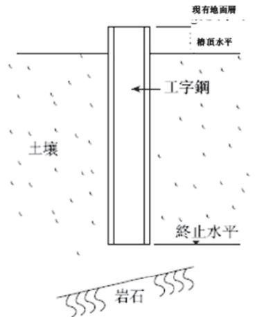
驅動工字樁(為撞擊式打樁的一種)工程一般涉及透過直接或間接錘擊或其他撞擊方法，包括使用吊錘(一般禁止使用)、雙動錘、單動錘、內部吊錘、氣錘、汽錘或其他撞擊儀器將鋼板工字樁、鋼板樁或混凝土樁打至所需深度。由於鋼板工字樁易於處理及驅動，故於香港獲廣泛使用。驅動工字樁為「磨擦樁」的一種，將樁柱與地之間的磨擦產生承受力。基於撞擊性質，此類樁基工程製造較多嘈音及振盪。在香港市區，樁基工程的作業時間一般限於每日3小時。由於涉及的機械體積佔用相對較少空間，故撞驅動工字樁適合用於有限空間的建築地盤。
