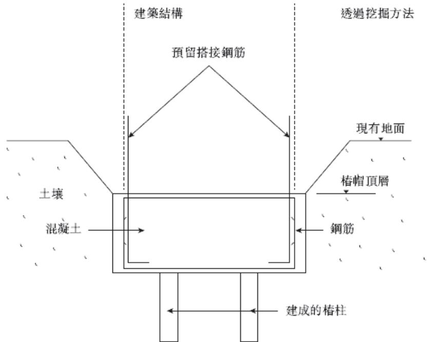
樁帽是建於一條樁柱或一組樁柱頭的混凝土構築物，用以將來自上面構築物的荷載轉移至該條樁柱或該組樁柱。
