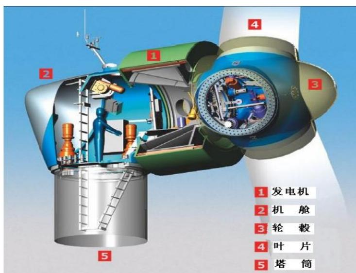
(2) 双馈式风力发电机组。双馈型的风机通过增速齿轮箱将旋转的速度提升，带动发电机发电，主要由叶轮、传动装置、发电机、变流器系统、控制系统等组成。双馈式永磁风电机组发电流程图如下：
