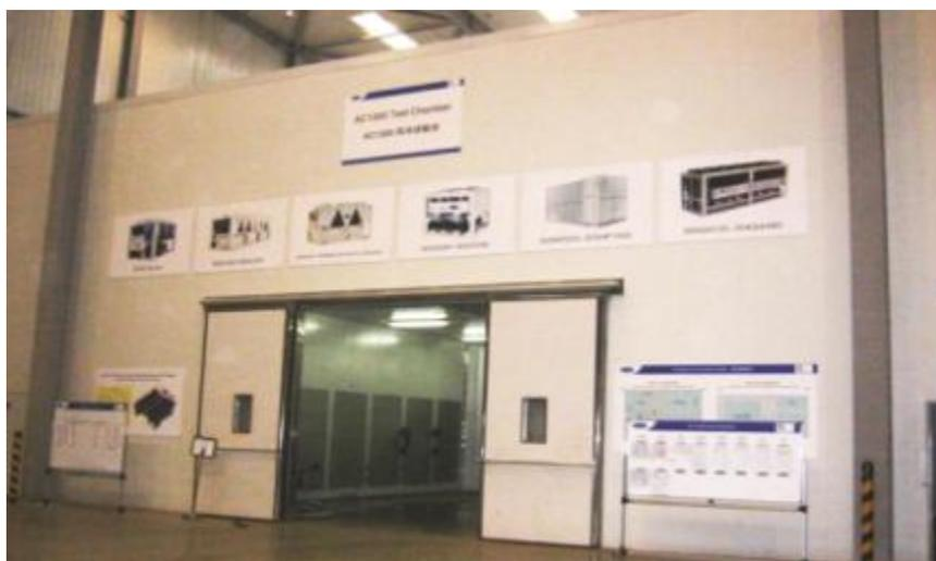
风冷商用空调主机试验装置
