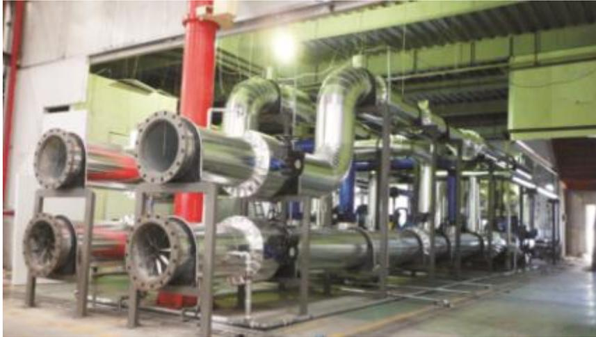
水冷商用空调主机试验装置
