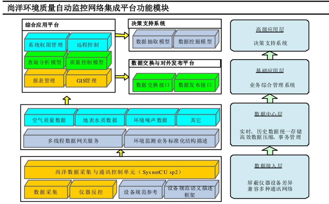
尚洋环科的监控平台为环境信息化建设提供了思路。传输层，结合不同地市网络现状和数据粒度（秒级、分钟、小时）方面的需求，制定科学的通信传输技术规范，统一各环节的数据传输；数据采集层，以公司成熟的数据采集技术，屏蔽现场仪器设备接口差异，使不同厂家、不同类型、不同接口的仪器在数采和控制方面得到统一；数据中心层，统一环境编码和代码，统一环境数据库结构和数据字典，集中存储水、气、声各类监测数据和管理信息；系统开放的技术共享体系体现在结合实际建设项目，协助客户培养环境信息化人才，做到自主开发、自主维护、自主改进。
