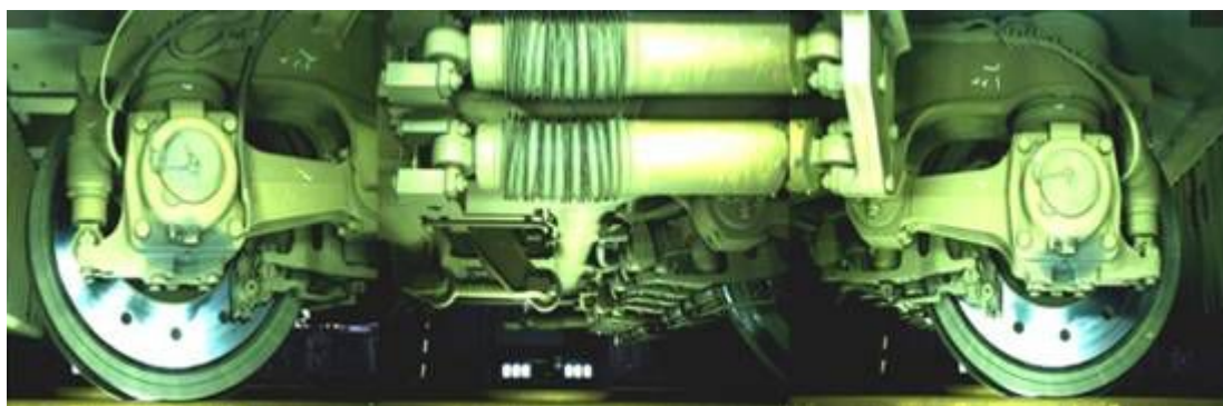
TEDS 拍摄的动车组侧部转向架图像
