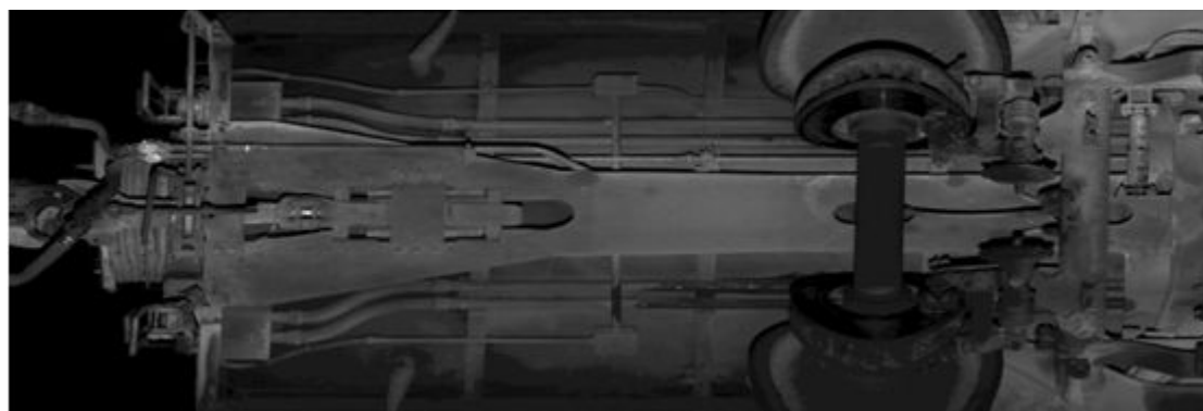
TVDS-3D 拍摄的车底部图像
