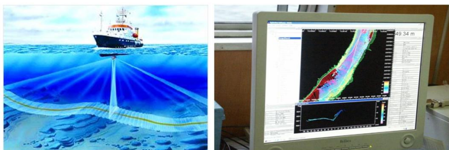
多波束测深仪工作示意图多波束实测水下地形图
