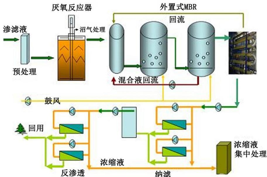
工艺流程：垃圾渗滤液经预处理进入厌氧反应器，厌氧出水进入双级硝化反硝化反应器，通过缺氧和好氧作用去除废水中的氮素和有机物。出水进入膜生化
