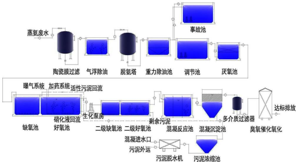
工艺流程：焦化废水经过陶瓷膜除油、气浮除油后将废水中的悬浮物、焦油类物质去除后进入蒸氨处理单元。在脱氨塔内将固定铵转化为游离氨从废水中脱除。蒸氨废水经过重力除油预处理、调节池均质后的废水进入厌氧反应器，进行厌氧水解酸化，一些难降解有机物转化为相对容易降解的有机物，缺氧反应器中发生反硝化反应进行脱氮。出水进入好氧反应器后，发生碳氧化反应，废水中绝大部分酚等有机物和氰化物等毒物得到去除；进入后置反硝化系统进行总氮脱除。好氧池出水进入混凝混合、反应池，经过混凝处理后的废水进入多介质过滤器，悬浮物进一步降低。出水进入臭氧催化反应器中，在催化剂作用下，废水中无法生物降解的有机物被氧化成容易生物降解的小分子有机物或部分矿化，废水得到净化，达到排放标准。
