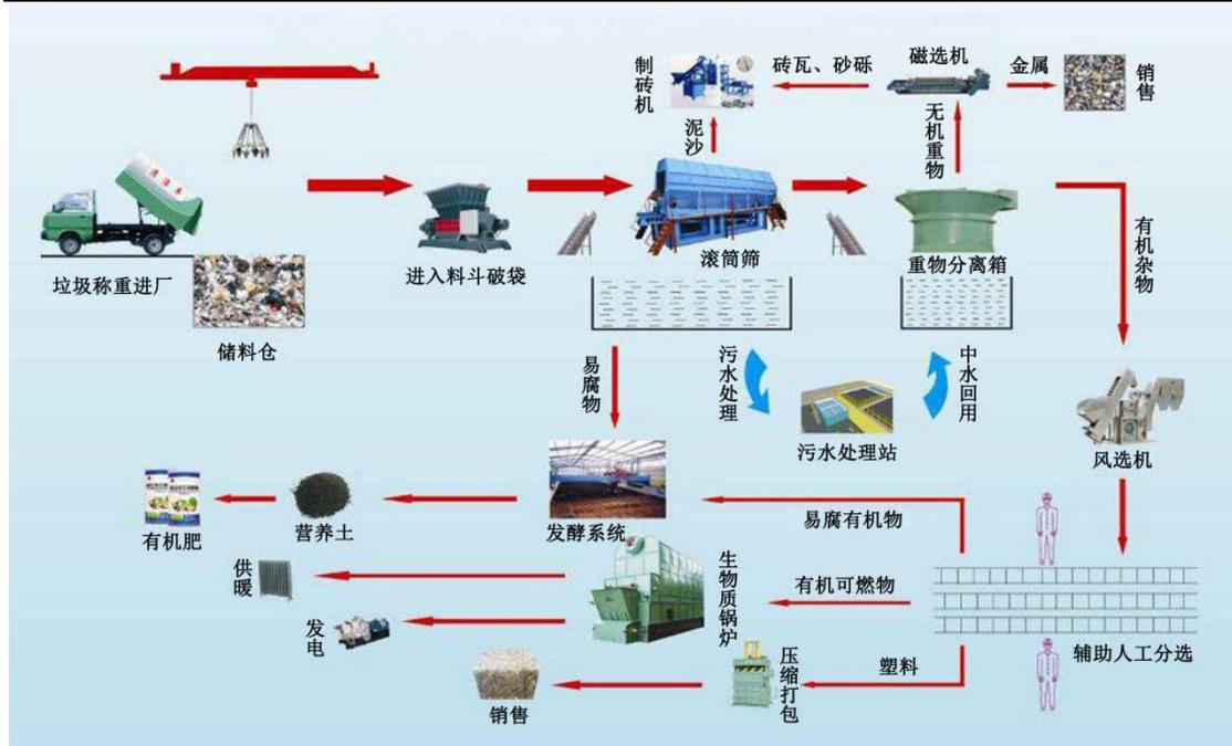
城市生活垃圾/餐厨垃圾/粪便等有机垃圾的生物处理技术主要包括好氧技术和厌氧技术,在此之前都要经过前处理过程,工艺流程为:生活垃圾称重进厂后,先经破袋、滚筒筛、磁选、风选等前处理程序,废弃物料和残渣进行卫生填埋处理,塑料纸张外运、金属回收外售。根据垃圾的种类和特性,可选择进行好氧堆肥或厌氧发酵的主处理工艺。垃圾综合处理系统内产生的渗沥液通过处理后达标排放,产生的臭气通过收集处理达标后排放。
