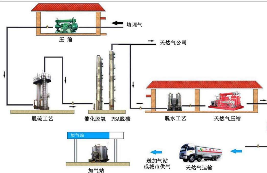
工艺流程：填埋气首先经压缩机进行压缩，然后经脱硫处理、催化脱氧处理、变压吸附脱碳处理、脱水处理等一系列技术工艺处理后，去除填埋气中的杂质组分，使之成为甲烷含量高、热值符合天然气标准要求的高品质燃气。天然气制取后，通过压缩，采用汽车运输方式，供给用户使用。
