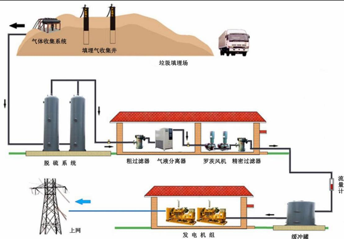
工艺流程：从填埋场收集到的填埋气经脱硫系统脱除其中的硫化氢，然后进入初级过滤器、气液分离器除去水分，再经罗茨风机增压输出、精密过滤器除去细小粉尘；经上述预处理过程的填埋气进入内燃机发电机组，产生的电能并入电网，供居民使用。
