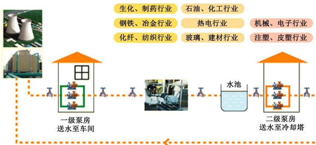
上图是节能水泵改造的适用行业与适用环境,由于设计与实践中的差异,当水泵投入运行后,常常会偏离高效区运行,华泰润达推出的水泵节能改造技术,就是通过检测当前运行的水系统的使用情况,分析判断出水循环系统各部分的能耗状况,并按此“量身定制”高效节能泵来更换原来使用的循环水泵,在系统工况不改变的前提下提高水泵的运行效率,大幅度降低能耗成本,以此实现节能改造的目的。
