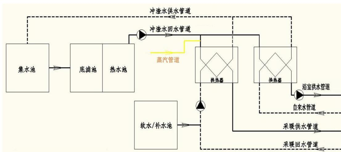
工艺流程：一次高炉冲渣循环水，经底滤过滤后，用冲渣水泵送至热力换热站，通过换热器把热量传给采暖循环水；高炉冲渣水温度由80℃变为65℃后，通过冲渣水循环管道回到冲渣水池，再次用于高炉冲渣，使其温度再次由65℃变为80℃后重新进入底滤池进行再次循环利用。采暖循环水经过换热器后，温度由50℃变为60℃。采暖水通过室外管网进入各建筑物进行采暖。采暖后，采暖水温度由60℃变为50℃，再通过采暖室外管网重新回到热力换热站，重新加热后循环使用。
