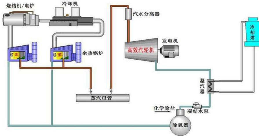
烧结环冷机余热回收工艺流程：余热锅炉系统用来回收环冷机一段冷却段及二段冷却段部分的高温废气余热，最大限度的产生的高品质蒸汽。为提高能源利用率，系统采用双压产汽系统，即高温废气产中压过热蒸汽并网、低温废气用来产低压蒸汽，一部分供自身系统热力除氧用，多余部分并网。
