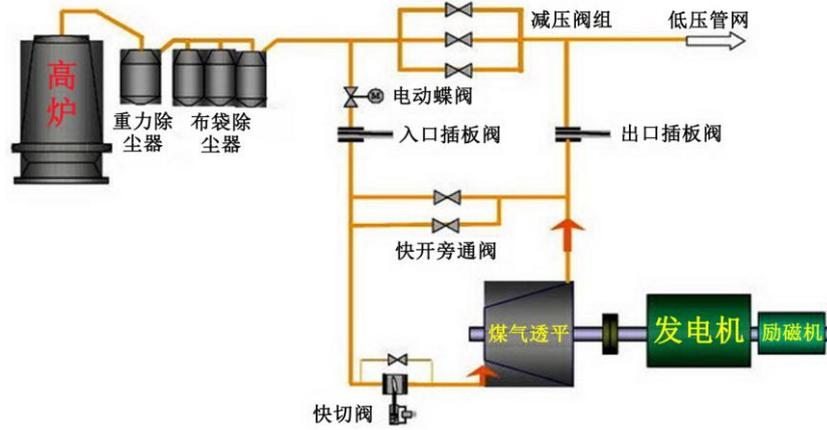
TRT 装置就是利用高压高炉煤气到低压煤气用户的压差能进行节能发电的一套装置。其主要工艺流程为：高炉煤气经重力除尘、干法布袋除尘后分为两路，一路经 TRT 入口蝶阀、电动插板阀、快速切断阀后进入 TRT 透平机做功，并带动发电机做功发电。TRT 装置设快开旁通阀，以保护机组的安全运行。TRT 透平机出口设出口电动插板阀等设施与低压煤气管网相连。
