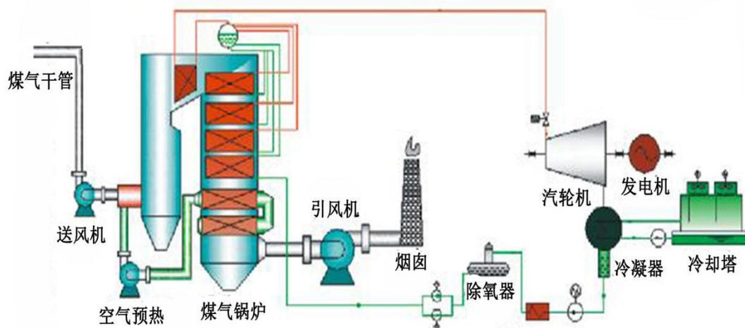
工艺流程: 煤气经过电动调节阀、电动蝶阀、速关阀和流量测量装置接往各燃烧器的支管, 空气经送风机加压送往空气预热器, 经空气预热器加热后的热风送往各燃烧器, 在燃烧器里与高炉煤气混合后送入炉膛燃烧。从锅炉尾部排出的烟气经引风机加压后, 通过烟囱排往大气。汽包内的饱和蒸汽经汽水分离器进入过热器, 过热后形成主蒸汽。主蒸汽进入汽轮机驱动汽轮机发电机组发电。做功后的乏汽经凝汽器冷凝形成凝结水, 由凝结水泵通过低加进入热力除氧器进行脱氧。
