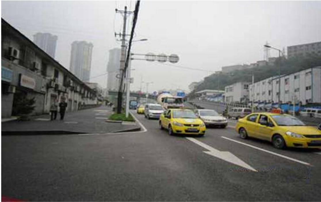
**工程简介：**石杨路拓宽改造工程起于石桥铺立交，经陈家坪立交、五台山立交，止于石坪桥立交，道路等级为城市主干道Ⅰ级，路幅宽 35 米，车行道由双向四车道扩宽为双向六车道，设计车速：50 公里/小时。
