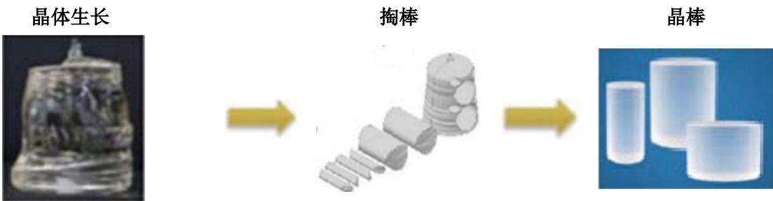
泡生法下晶棒生产流程，图片来源：《西南药业股份有限公司重大资产置换及发行股份购买资产并募集配套资金暨关联交易报告书》
