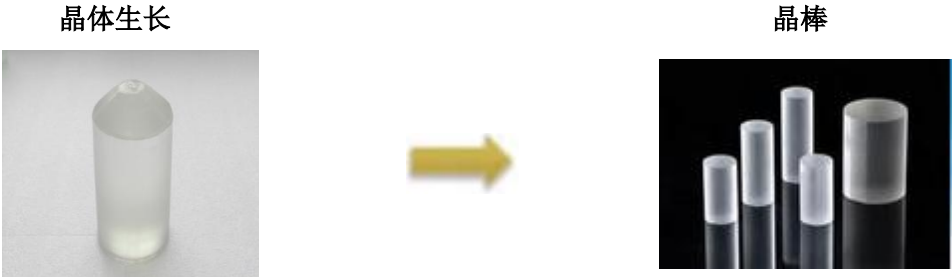
“同步搅拌感应加热坩埚下降法”下晶棒生产流程
