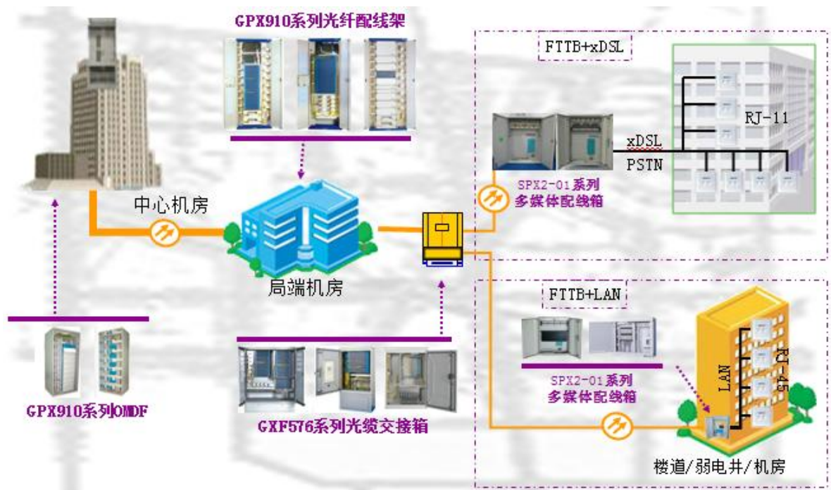
图 4-9 光纤到节点（FTTC）解决方案产品应用拓扑图
