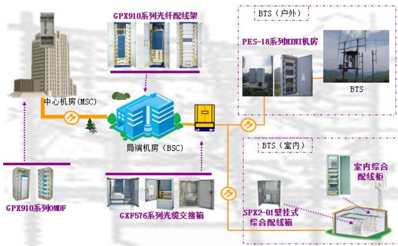
图 4-11 无线基站（FTTA）解决方案产品应用拓朴图
