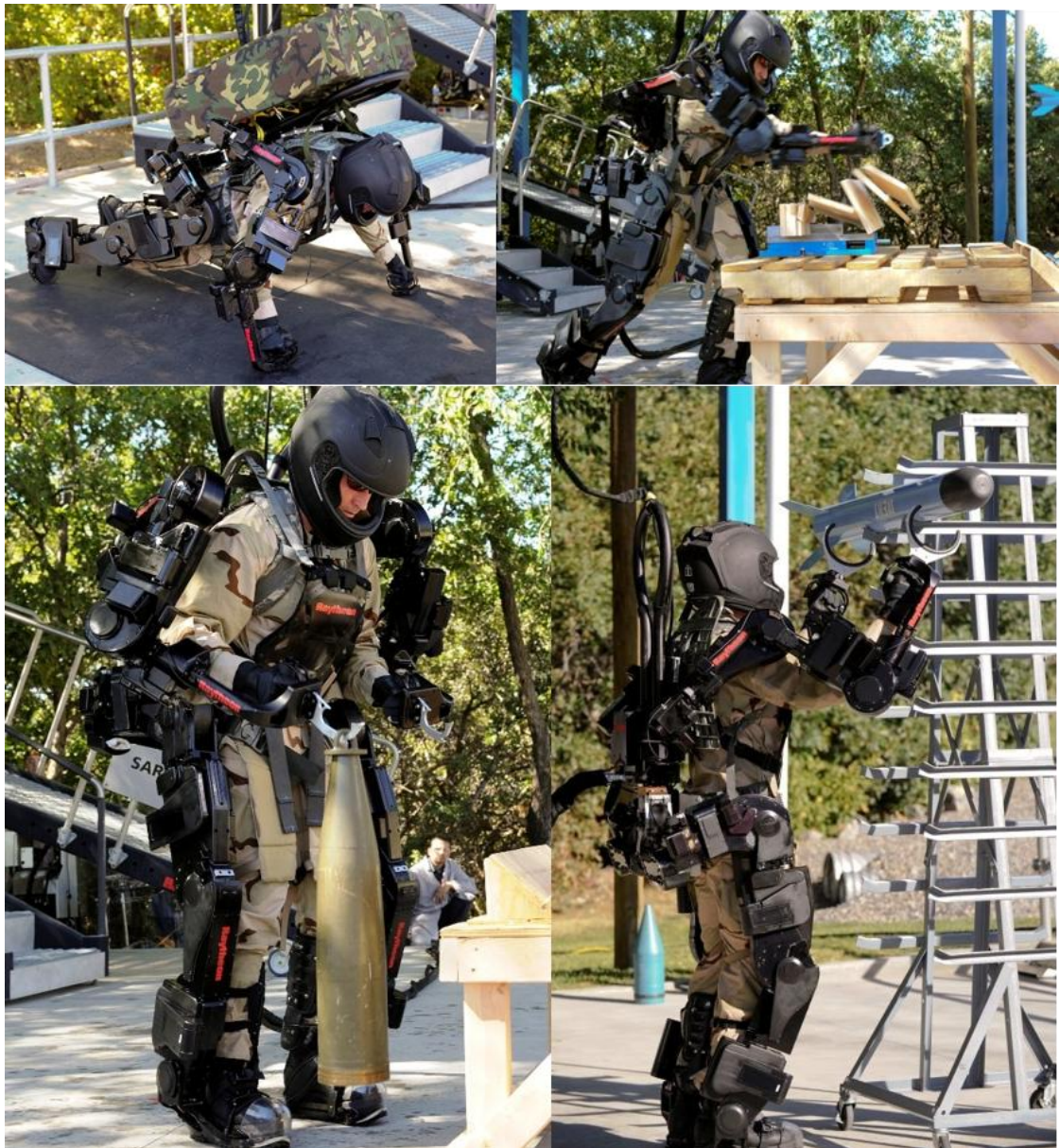
图 3：美国 Raytheon Sarcos XOS 2 外骨骼机器人进行负重、击打演示，可进行 100 升背包俯卧撑、单手提起 155 毫米榴弹炮弹药等
