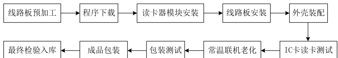
③ 指纹智能平板生产及检验流程图
