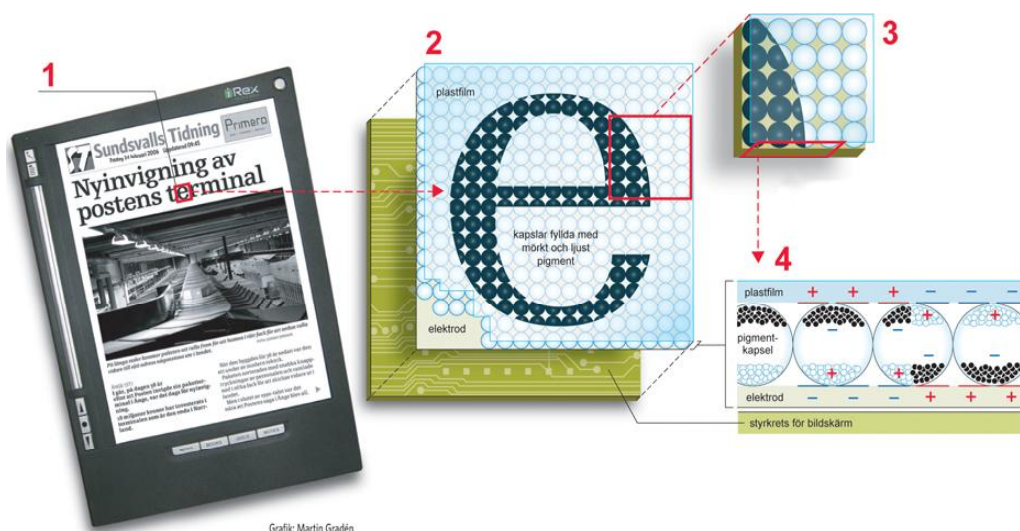
图：电子纸显示原理
