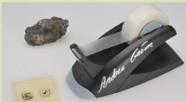
诺沃肖洛夫团队首次制备石墨烯所用装置
