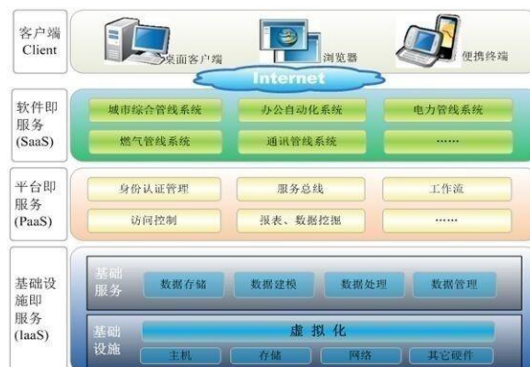
图5 智慧市政一体化监管平台综合系统
