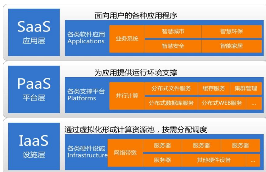
图6 汉威云平台架构示意图
