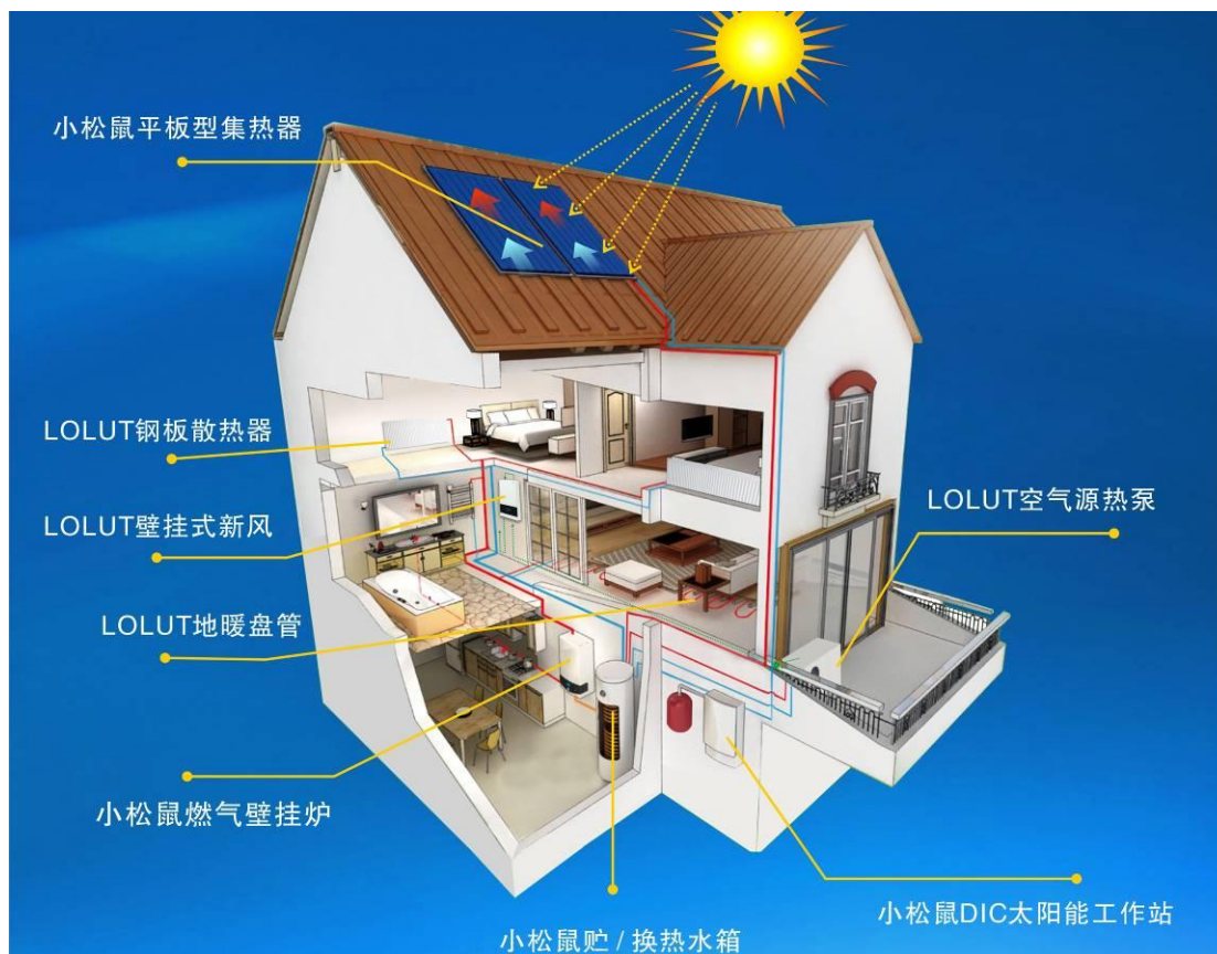
图3：新风系统在健康家居环境平台中的应用示意图
