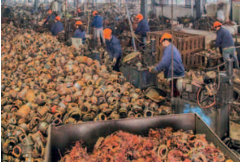
Workshop (3) Pull out copper string 工作間(3)拉出銅線
