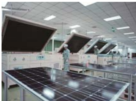
光伏组件生产线
