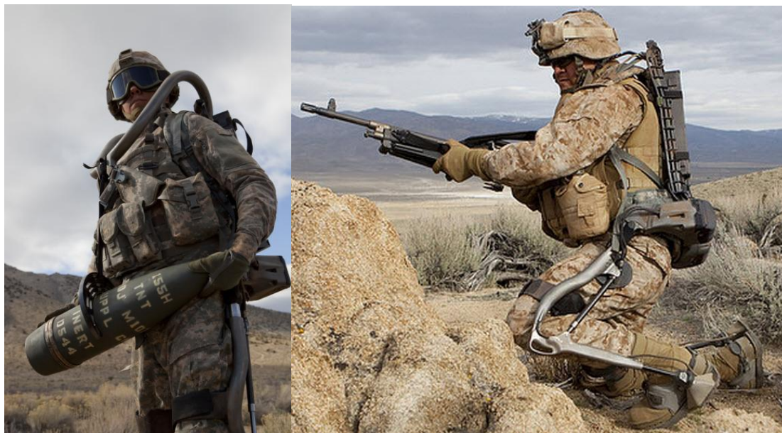
图 4：美军外骨骼机器人 HULC
