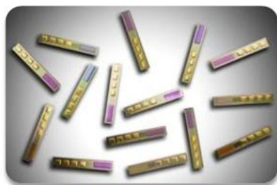
检测冠状动脉血压的压力传感器
