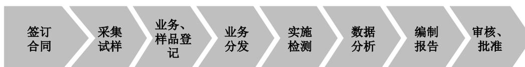
中钢制品院在与客户签订合同后首先将采集试样，随后将样品进行登记，并根据样品或业务的种类分发至检测小组。检测小组收到分发的业务后开展检测和数据分析，并将结论形成报告。检测报告经内部审核部门审核及批准后将交送至客户。
