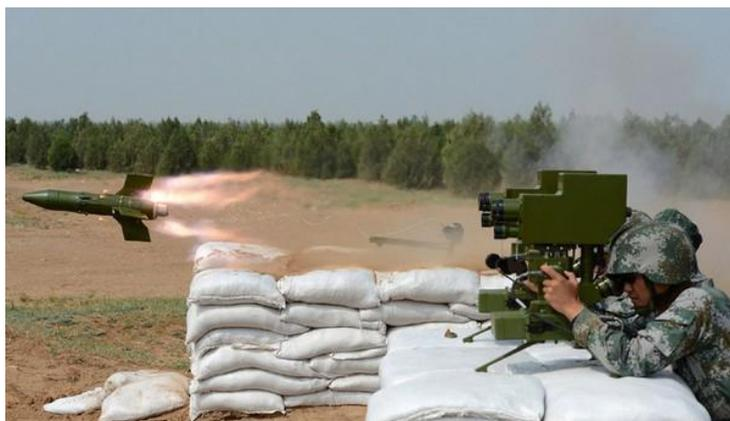
师凯科技的产品目前主要用做反坦克导弹的光学瞄准及跟踪制导系统，通过可见光或红外线，实时接收引导源信息，完成目标的探测、捕获、跟踪、锁定。主要工作原理是测量受控目标与瞄准指令之间相对偏差角，并据此形成修正飞行轨迹指令，使偏移的受控目标继续沿瞄准线方向飞行，最终击中目标，产品主要用途如下：
