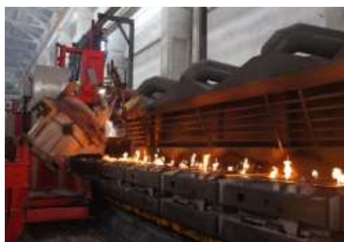
铸件自动生产线金属熔炼浇注现场
