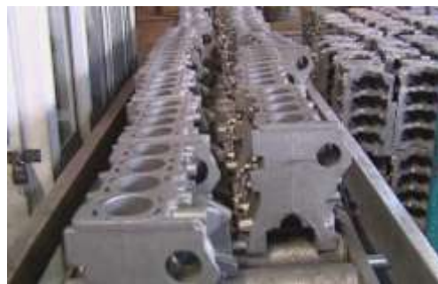
清理后的缸体铸件
