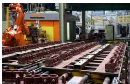
冷芯盒树脂砂型砂/芯砂的配制与铸型/型芯制造现场
