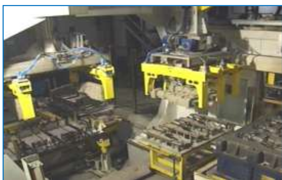
冷芯盒树脂砂型砂/芯砂的配制与铸型/型芯制造现场
