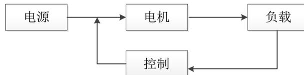
电机系统节能的一个主要途径是使用变频调速技术，其原理就是通过改变输入电机的电源频率来调节电机的转速。变频调速技术目前在风机、泵类负载设备的节能中应用的最为广泛，原因是风机、泵类负载的耗电功率与转速的立方成正比。采用高压变频器对风机、水泵等设备进行节能改造，通过改变电机的转速，从而改变风机风量、水泵流量以适应生产工艺的需要，使得运行功率处于最合适的状态，降低能耗。
