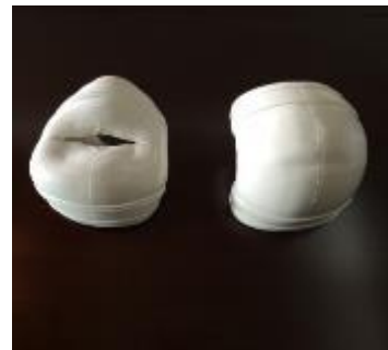
图：烘箱试验，左边为侧胶口注射样品，右边为端面注射样品。
