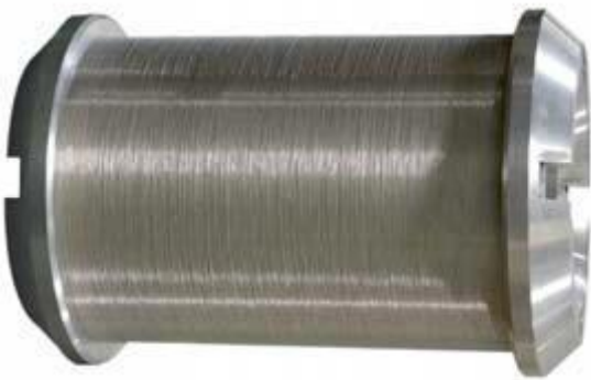
上图：卷绕在工字轮上的成品电镀金刚石线
