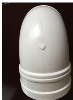
图：侧胶口注射成型样品
