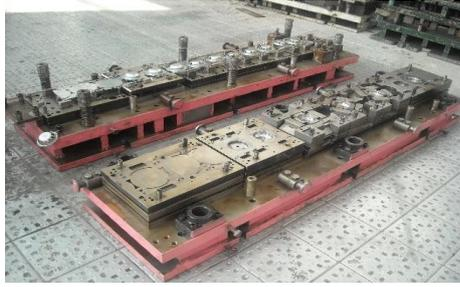
用于生产方向盘支架，此碗型支架中间由客户安装气囊组件，供货上海大众。此产品产量较大，客户质量要求高，此技术方案能同时满足客户的产能、质量、成本等多方面的要求，只是模具难度大大提高。
