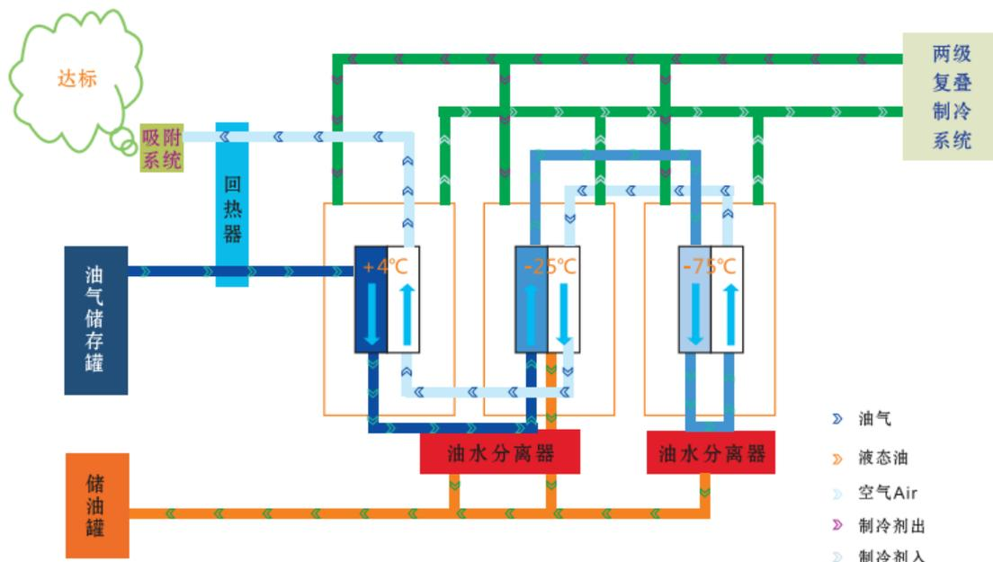
35℃的油气由主油气管经过管路过滤器后由防爆风泵送入冷凝主机，风泵和装在油气主管上的压力传感器联锁，根据发油量的大小自动变频运行。油气在冷凝主机内被多级梯度降温，先是经回热交换器和出冷场的油气进行回热交换，被冷却到-25℃（温度可调），析出一部分油，再进入第二级冷凝箱冷却至-75℃，进一步析出一部分油，至此约92%的烃类组分被分离出来，分离出油后的低温贫油气体再依次回到第一级冷凝箱、预冷器、回热交换器，温度回升到25℃左右，进入到吸附系统（吸附系统由两吸附罐交替进行吸附——脱附——清扫过程），经过吸附系统分离出来的达标尾气经阻火器安全排空，回收到的液态油与制冷系统的排气热量进行回热置换，冷量全部回收利用，油品全部以常温状态离开冷场进入储油罐。
