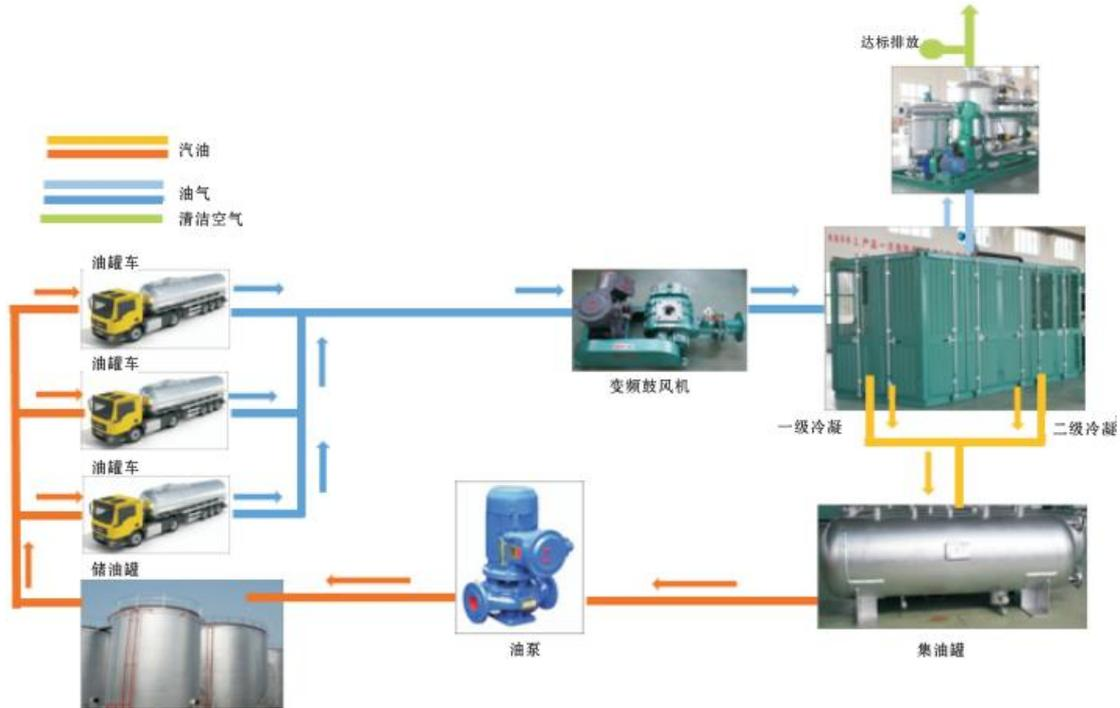
都乐制冷油气回收系统工作流程分为 7 个步骤：①把敞开式装车罐更换成密闭式装车鹤管；②鹤管卸油时，系统启动；③通过转速调节风泵抽气能力，适时跟踪油罐车装载速度；④被收集的油气集中输送到储气罐中，平衡稳定后输送到冷凝机组；⑤通过“冷凝+吸附”的方式将油气转化为液体油；⑥处理后的达标尾气排向大气；⑦回收的汽油通过油泵返回储油罐。
