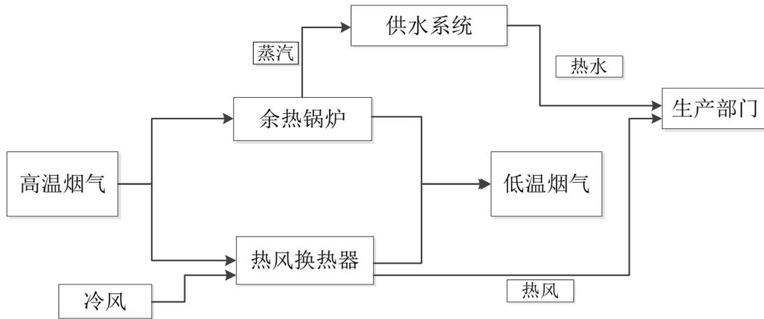
余热锅炉利用高温烟气，将锅炉内的水转化为蒸汽，蒸汽积累到了一定的温度和压力，开始排出，进入到供水系统，将供水系统内的冷水加热成热水，供给给生产部门或者居民使用。热风换热器则是利用高温烟气的热量，将进入换热器内的冷风加热成热风排出，用于生产环节中使用。高温烟气经过余热回收利用，最终变成低温烟气排到空气中，既可以节省用能单位原需采购的蒸汽或者燃煤，也可以降低烟气的热污染。
