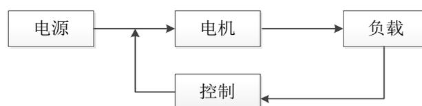
电机系统节能的一个主要途径是使用变频调速技术，其原理就是通过改变输入电机的电源频率来调节电机的转速。变频调速技术目前在风机、泵类负载设备的节能中应用的最为广泛，原因是风机、泵类负载的耗电功率与转速的立方成正比。采用高压变频器对风机、水泵等设备进行节能改造，通过改变电机的转速，从而改变风机风量、水泵流量以适应生产工艺的需要，使得运行功率处于最合适的状态，降低能耗。
