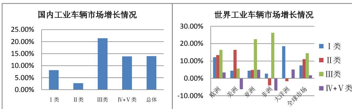
(注：I 类产品为电动平衡重乘驾式叉车，II 类产品为电动乘驾式仓储车辆，III 类产品为电动步行式仓储车辆，IV+V 类产品为内燃平衡重式叉车；数据来源为中国工业车辆分会统计数据。)
