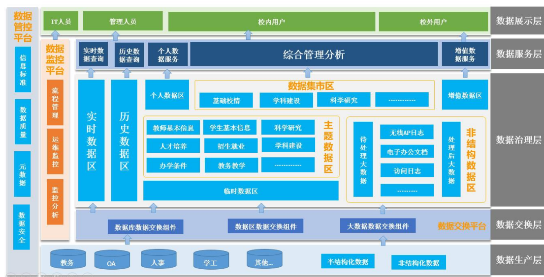
图 高校大数据中心系统结构图
